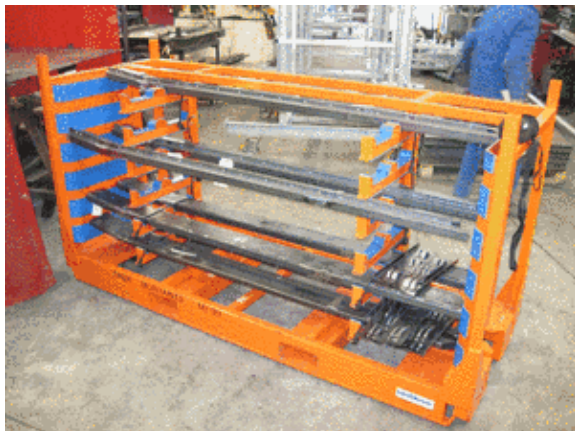
Anwendungsbeispiel: Ladungsträger für lackierte Querträger
